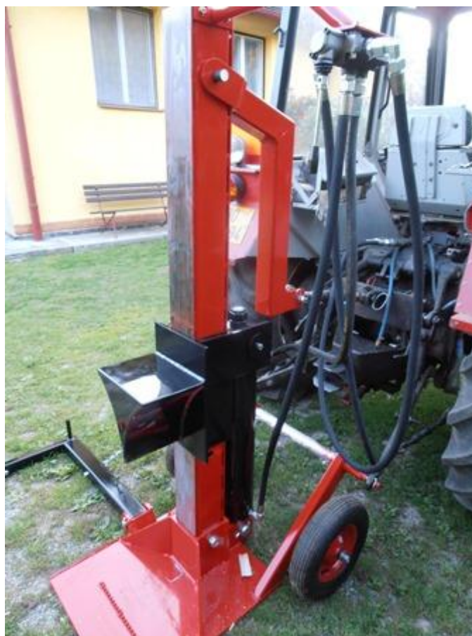
Obr. 7 Štípačka s připojením na hydraulický okruh traktoru [7]
