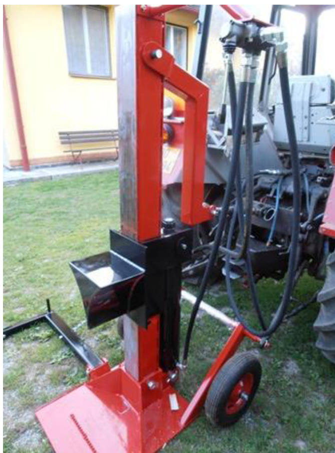
Obr. 7 Štípačka s připojením na hydraulický okruh traktoru [7]
