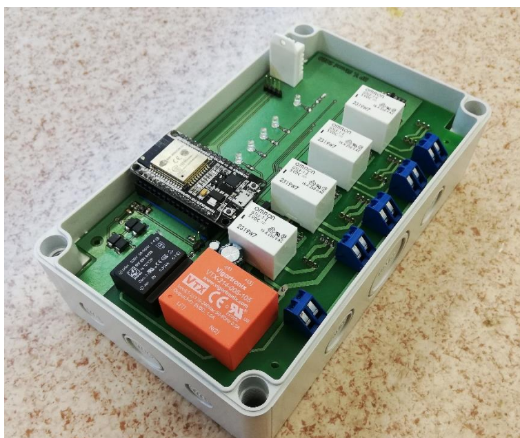
Obrázek 18: Kompletně osazená DPS uvnitř krabičky (vlastní)
