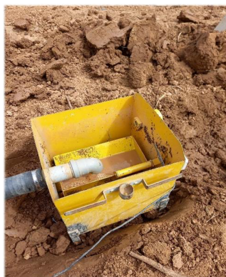
Obr. 24: Člunkový průtokoměr – překlápěčka (foto autorka, 2023)
