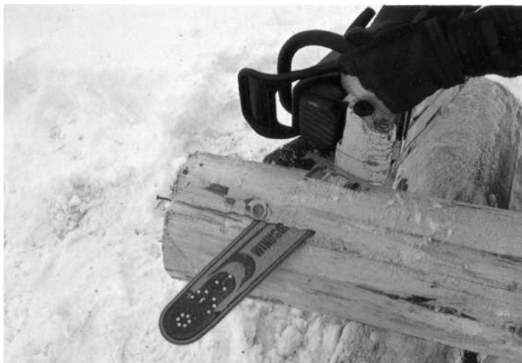
Obr. 4.4 Správné pokračování řezu [8]
