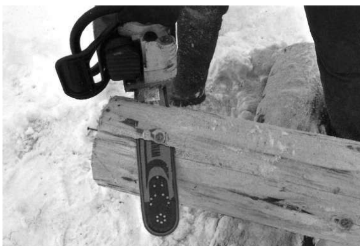
Obr. 4.3 Správná poloha motorové pily [8]
