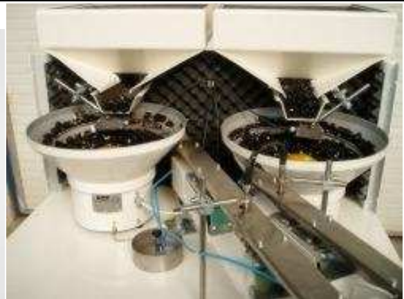
Obr.4 V levo předzásobník, v pravo ukázka předzásobníků a podavačů na reálné aplikaci. [zdroj:Vondra-vondra, Rox]
