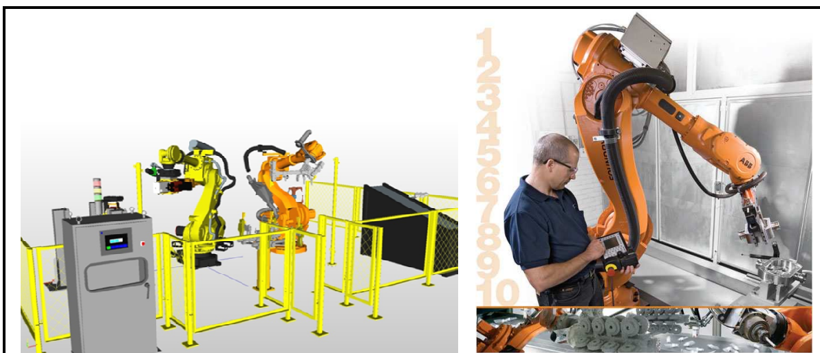
Obr.28 Vlevo simulace robotizovaného pracoviště, vpravo on-line programování robotu. [zdroj: Axiomtech]
