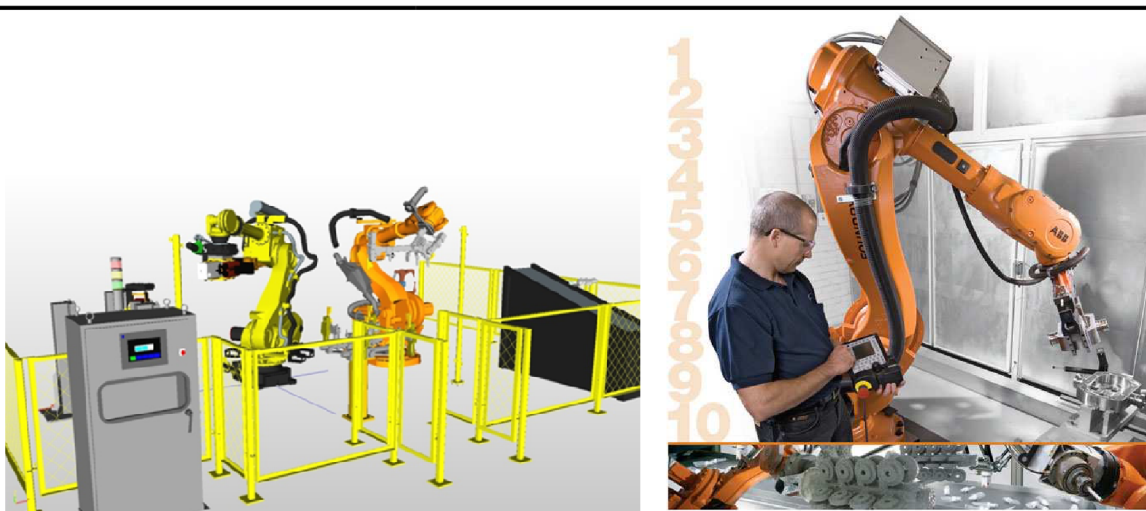
Obr.28 Vlevo simulace robotizovaného pracoviště, vpravo on-line programování robotu. [zdroj: Axiomtech]
