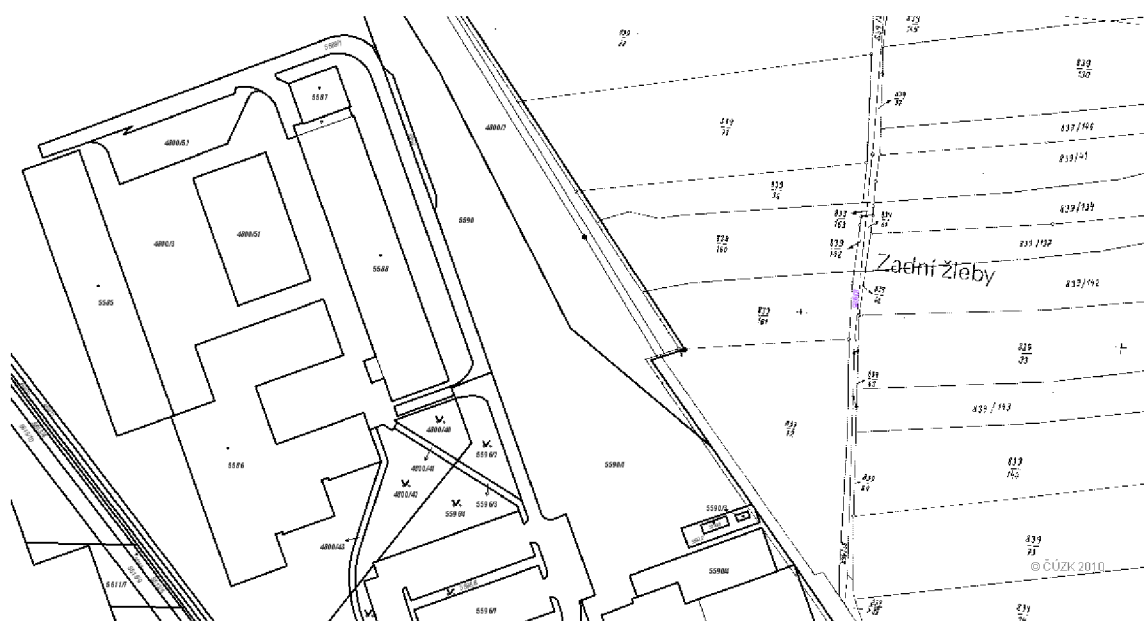
Obr. 4: Ukázka digitální katastrální mapy zobrazené v programu JanMap v měřítku 1:1 132 (zobrazena budova VUT Podnikatelské fakulty a přilehlých pozemků)
