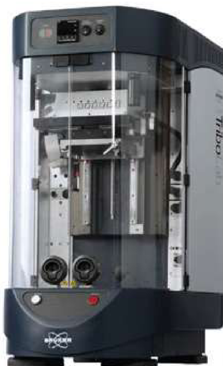
Obrázek 4-1: Reciproční tribometr od firmy Bruker [18]
