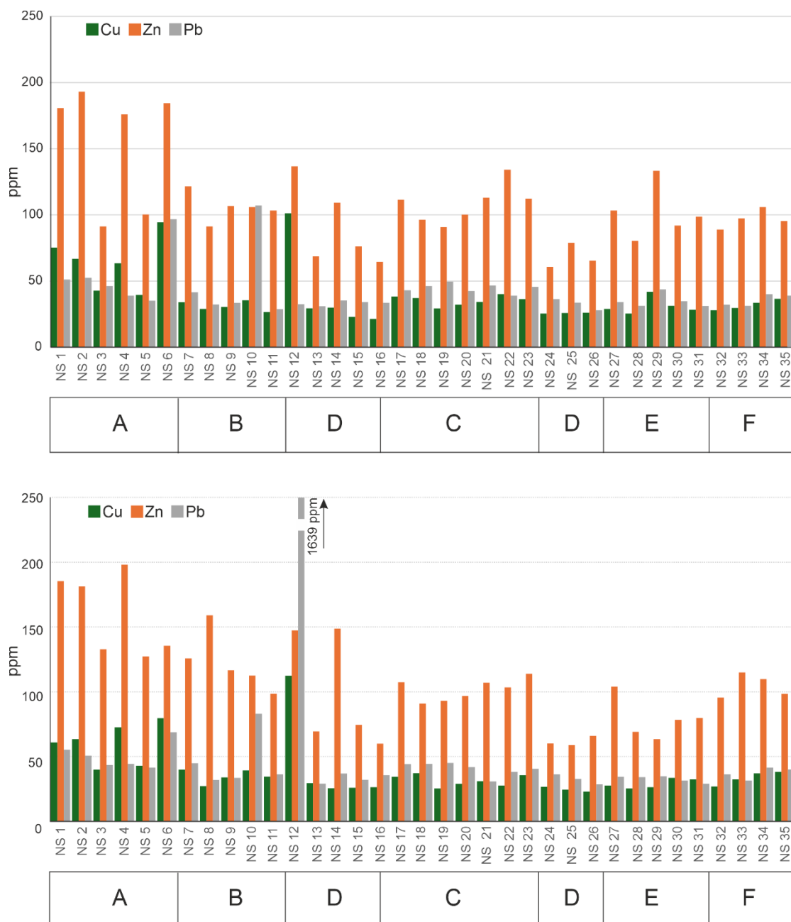
Obr. 18: Naměřené koncentrace Cu, Zn a Pb pro obě vrstvy s vyznačením jednotlivých zón. Nahoře vrstva 0-5 cm; dole vrstva 5-10 cm.
