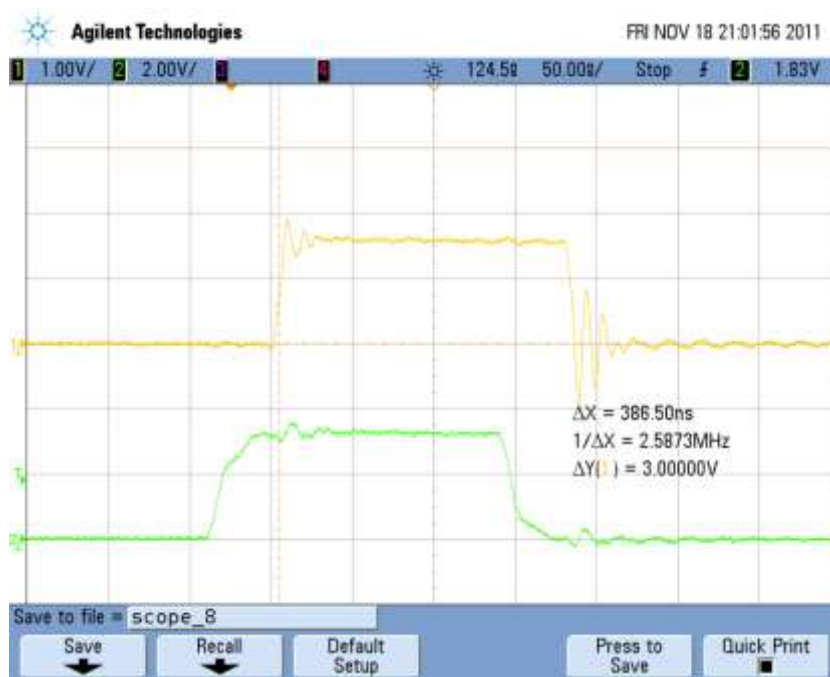
Obrázek 35: Zobrazení průběhů z testování obvodu LM5111 spolu s BSS138N, zatěžovacím odporem R=32 \Omega a keramickým kondenzátorem na napájení obvodu LM5111 o velikosti 330 nF
