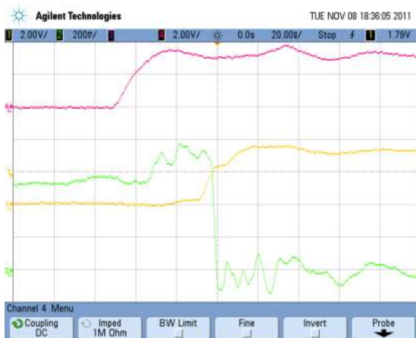
Obrázek 39: Detailní zobrazení průběhů v okamžiku spuštění převodu A/Č převodníku AD7685
