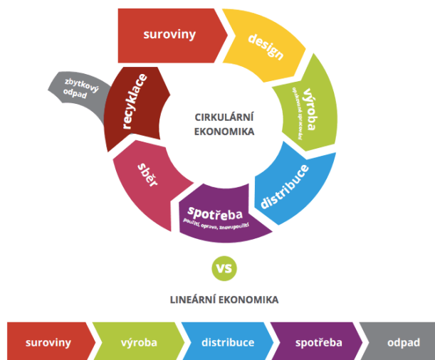
Obr. 2. Princip oběhového a lineárního hospodářství a materiálový tok[19]
