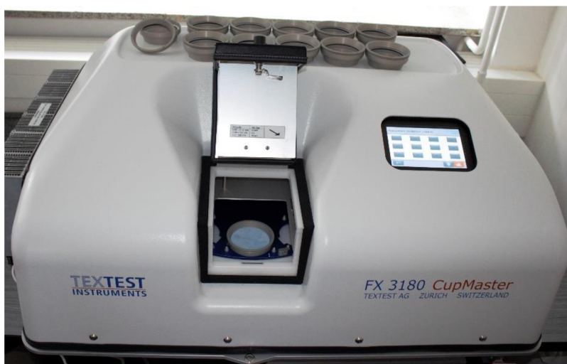
Obr. 6. Přístroj na měření paropropustnosti CupMaster[60]
