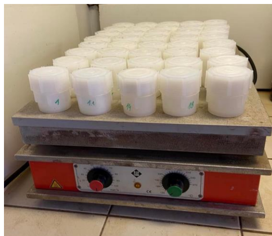
Obrázek 10: Zahřívající se vzorky při uzavřeném rozkladu
