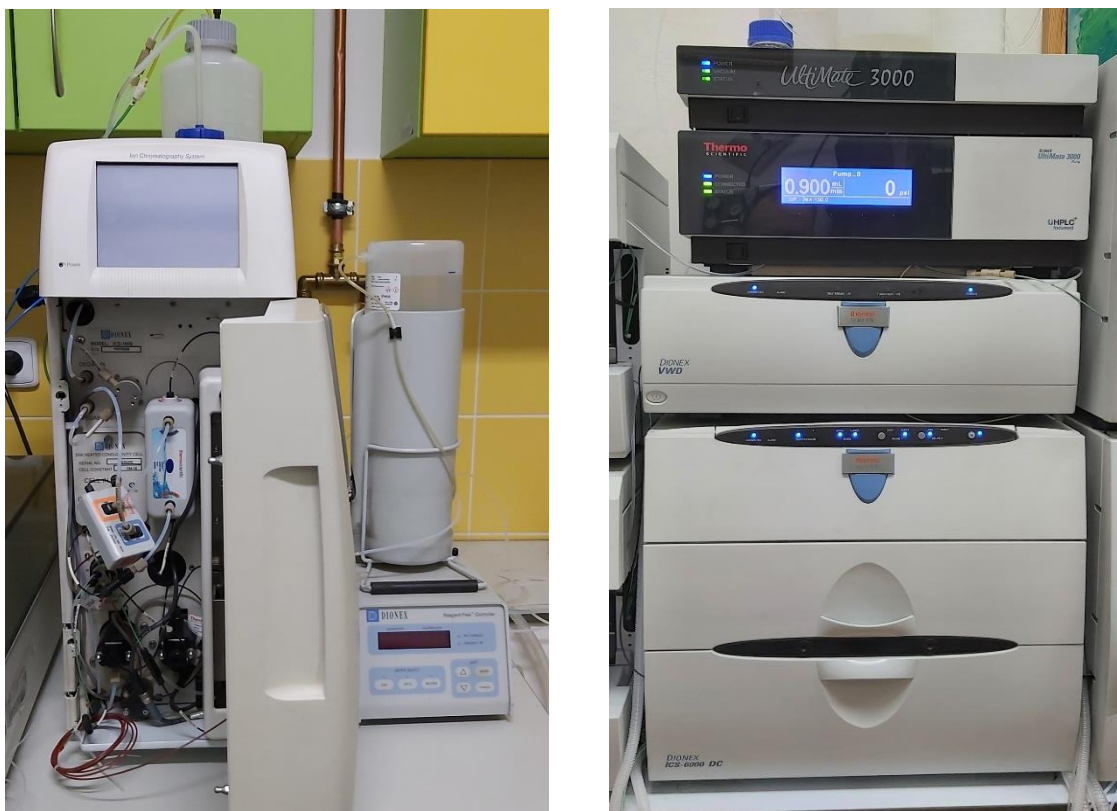
Obrázek 8: Systémy iontové chromatografie Dionex ICS 1600 (vpravo) a Dionex ICS 6000 DC (vlevo)
