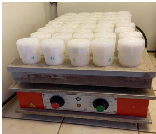
Obrázek 10: Zahřívající se vzorky při uzavřeném rozkladu
