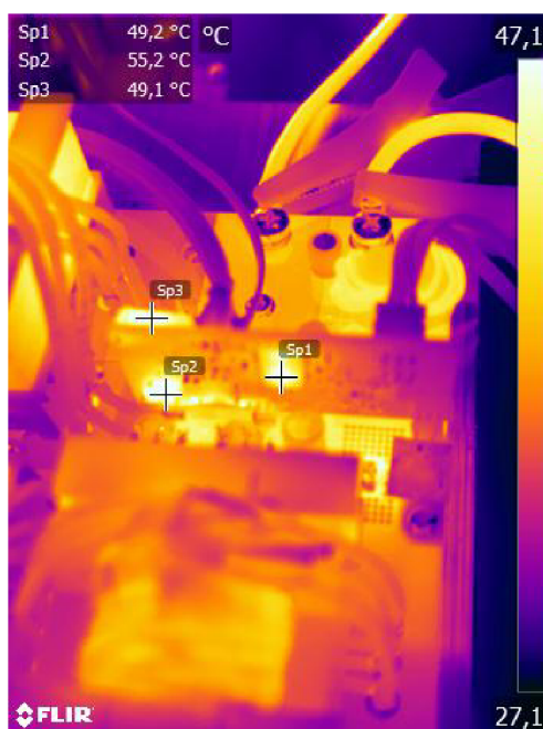
Obrázok 5.11 Záznam z termokamery – riadiaca DPS
