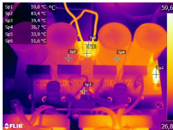
Obrázok 5.9 Záznam z termokamery – primárna DPS
