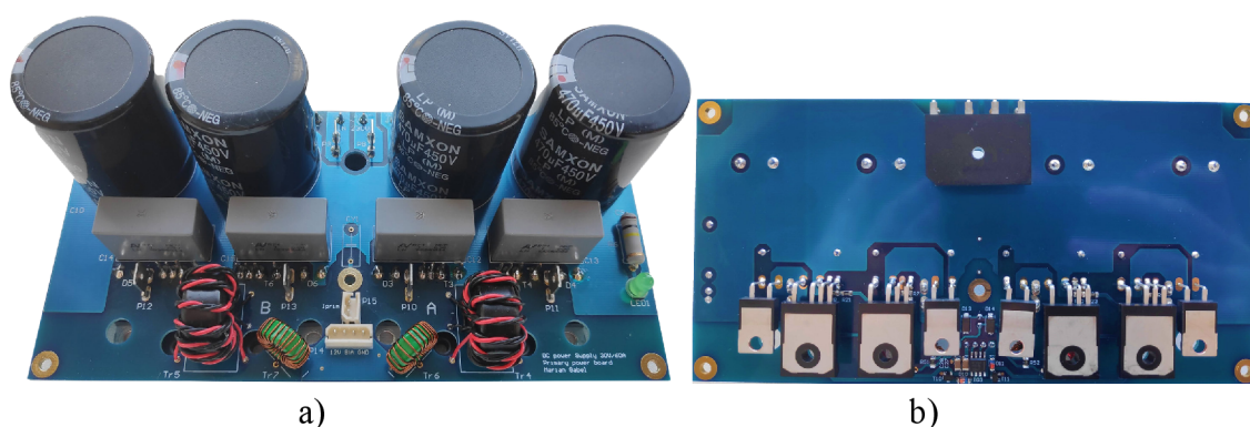
Obrázok 4.3 Primárna silová DPS (171,1 x 85,7 mm), a) horná strana, b) spodná strana
