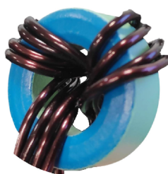
Obrázok 2.12 Navinutá cievka filtra druhého stupňa
