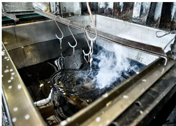
Obr. 25 Solná lázeň s přísadou kyanidů [24]
