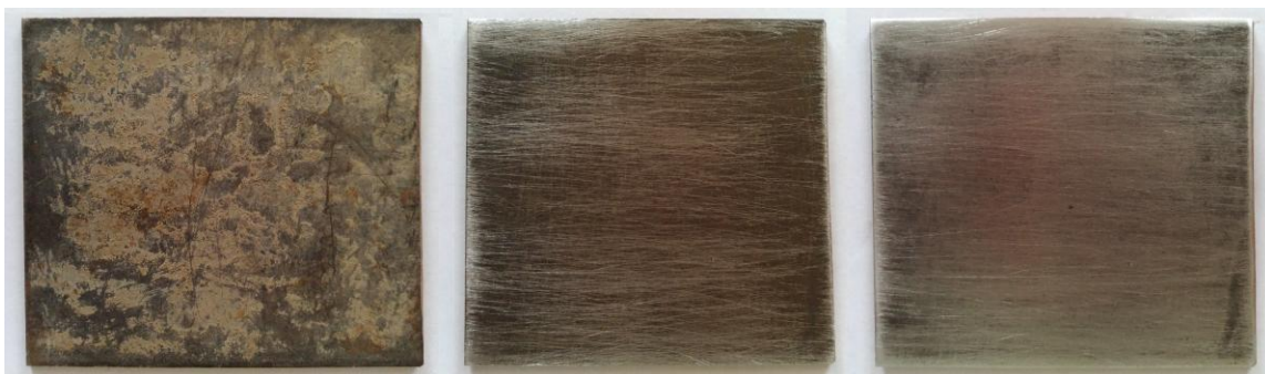
Obr. 32 Povrch materiálu před broušením a po v závislosti na velikosti brusného zrna
