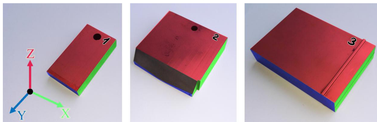
Obr. 14 Vzorky s barevně zvýrazněnými měřenými plochami
