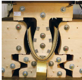
Obr. 7 Lepení ozvučnice reproduktoru B&W [4]
