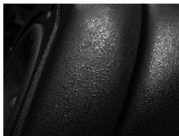
Obr. 11 Detail materiálu Q-stone používaného společností Green Mountain Audio [13]
