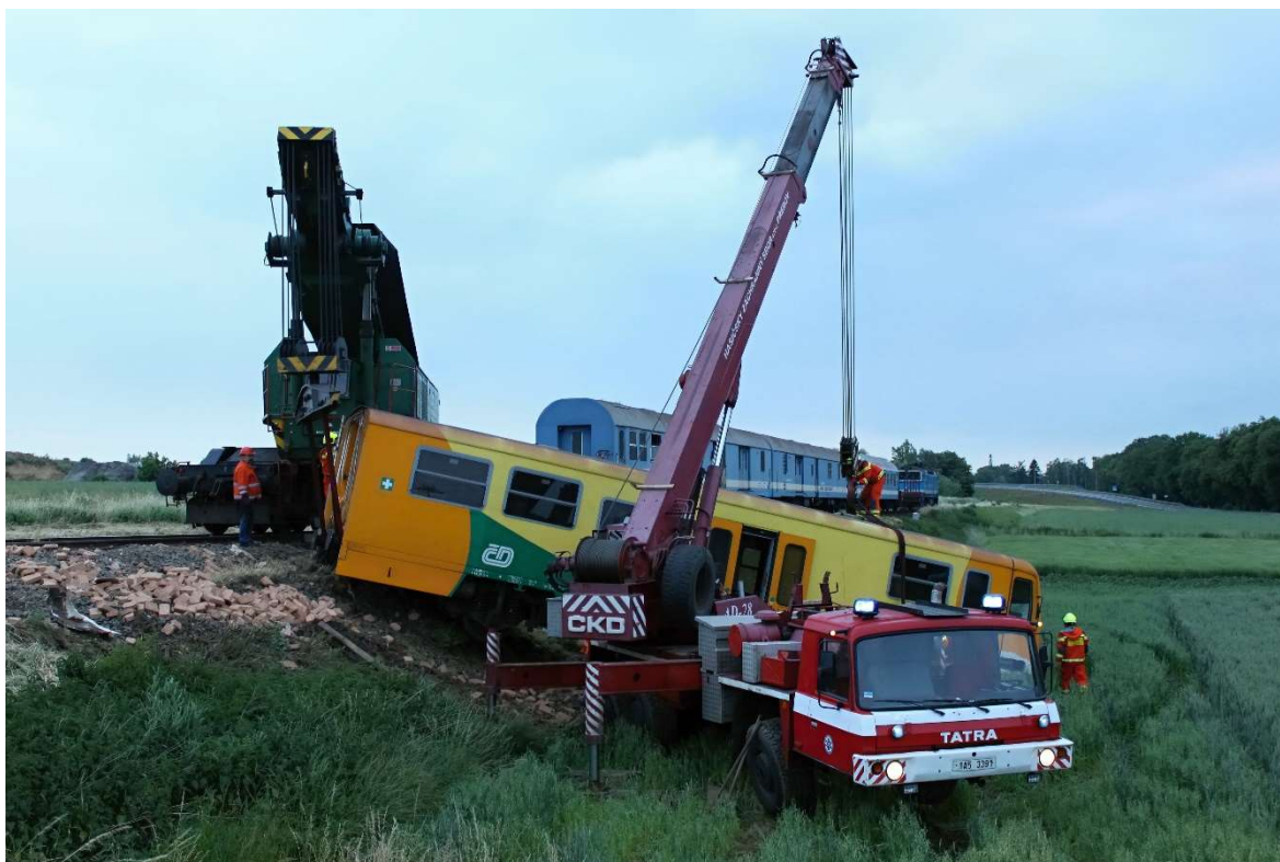
Obrázek 8 Použití automobilového jeřábu ve spolupráci s železničním jeřábem. Foto HZS Správy železnic Přerov
