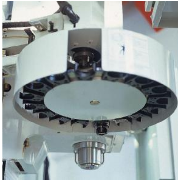
Obr. 1.6.1 Zásobník nástrojů frézovacího centra (bubnový) [21]
