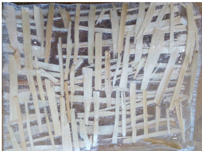
Obr. 22 Navrstvená deska po vytvrnutí a vytěkání DICHLOTMETHANU s velkým obsahem nežádoucích vzduchových bublinek. (Kolomazník – vlastní foto 2017)
