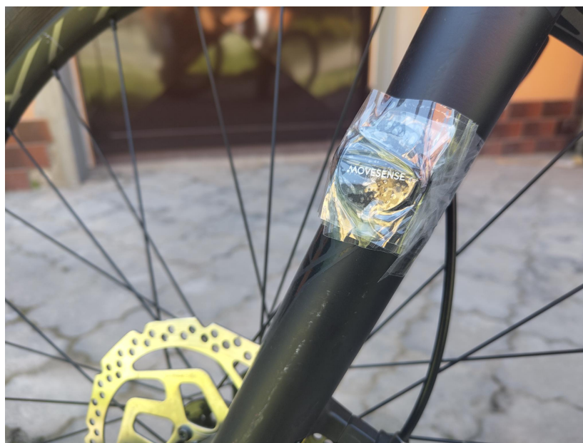
Obrázek 5: Upevnění senzoru na kole
