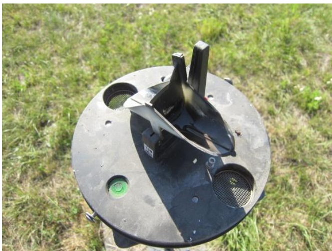
Obr. 12 Člunkový srážkoměr používaný v síti BVK, a.s.
