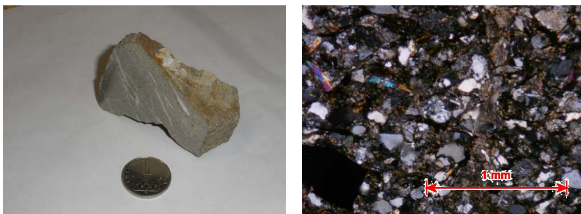
Obr. 29 a 30: Fotografie makrovzorku a mikrofotografie v XPL
