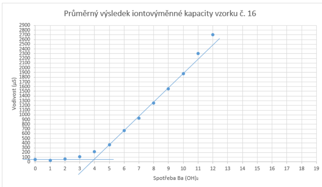
Graf č. 20.: Vyjádření spotřeby Ba(OH)_2 pro určení iontovýměnné kapacity T dle Sandhoffa.
