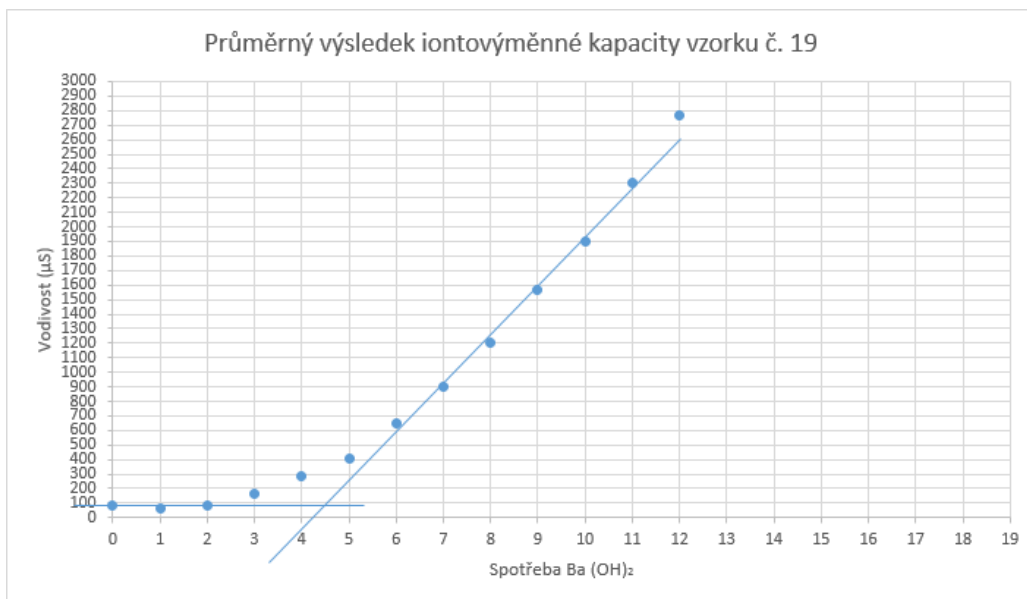
Graf č. 23.: Vyjádření spotřeby Ba(OH)_2 pro určení iontovýměnné kapacity T dle Sandhoffa.
