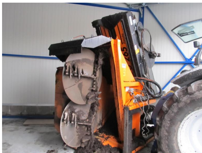
Obr. č. 7.: Překopávač bioodpadu Doppstadt
