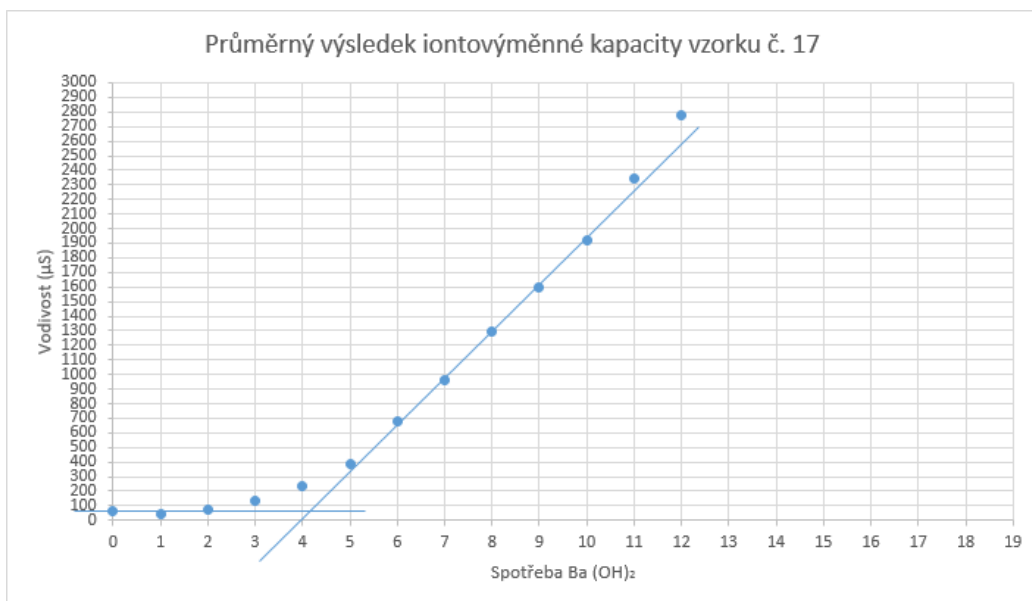
Graf č. 21.: Vyjádření spotřeby Ba(OH)_2 pro určení iontovýměnné kapacity T dle Sandhoffa.
