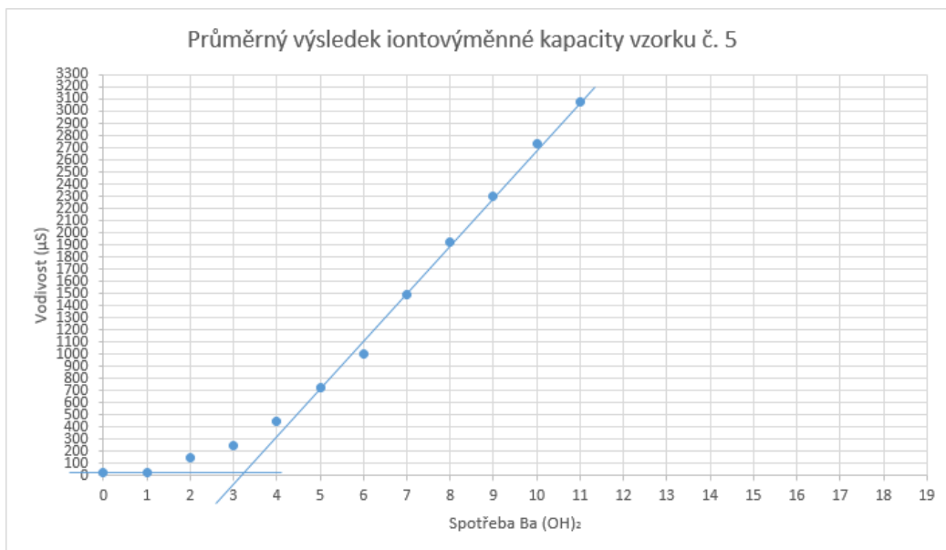
Graf č. 9.: Vyjádření spotřeby Ba(OH)_2 pro určení iontovýměnné kapacity T dle Sandhoffa.
