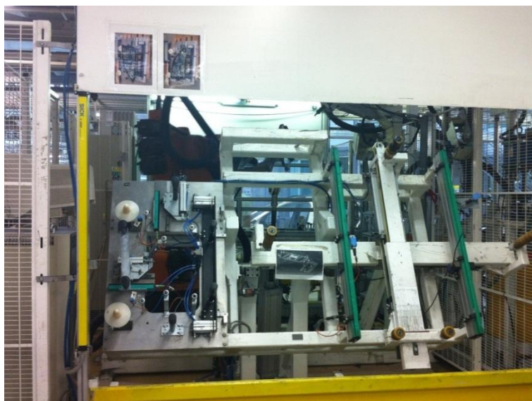
Obr. 9 Nakloněný stůl na odvrácené straně montážní linky [22].
