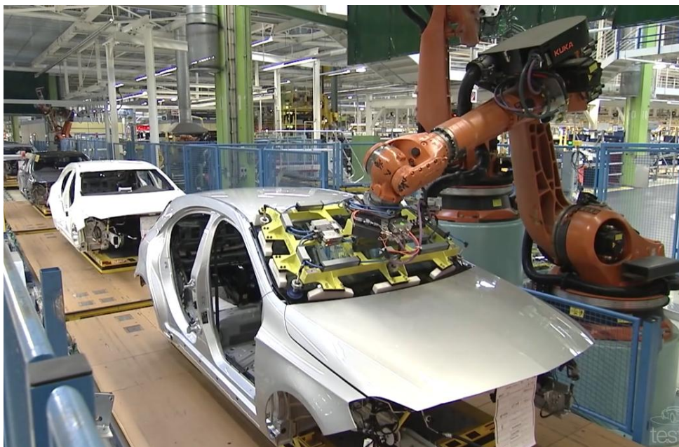
Obr. 15 Montáž čelního skla automobilu Mercedes A-Class [31].
