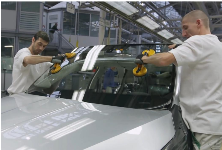
Obr. 12 Současný stav manuální montáže při pohledu zvenku [24].
