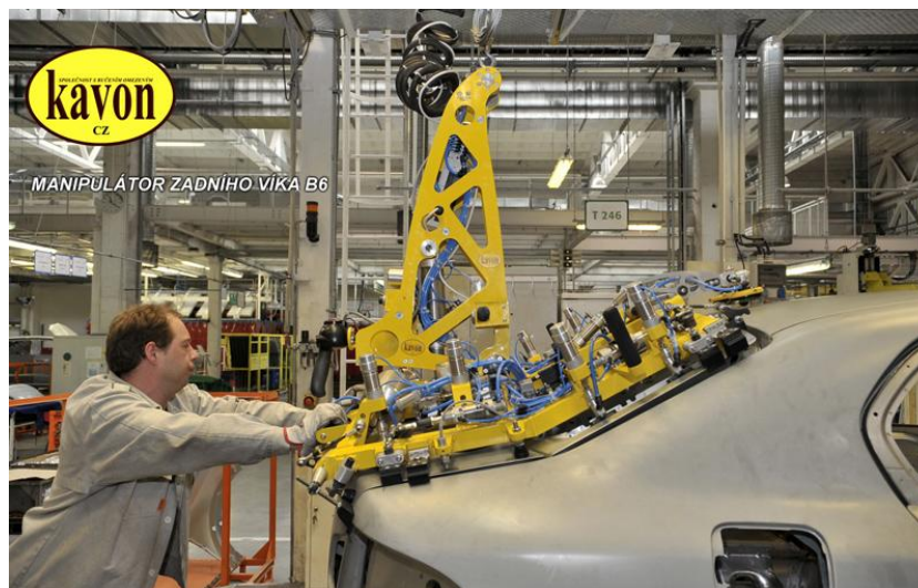
Obr. 14 Manipulátor zadního víka vyrobený firmou Kavon, Škoda Superb [27].
