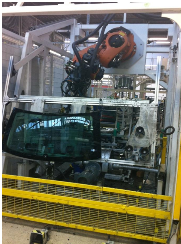
Obr. 10 Zadní sklo s aplikovaným lepidlem [22].
