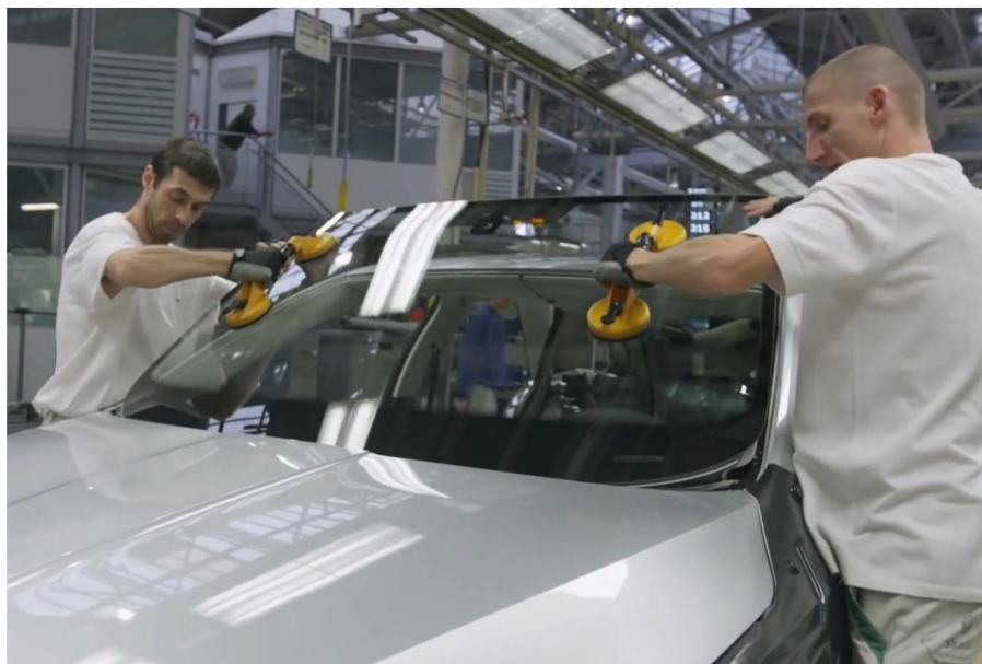
Obr. 12 Současný stav manuální montáže při pohledu zvenku [24].
