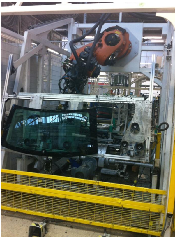
Obr. 10 Zadní sklo s aplikovaným lepidlem [22].
