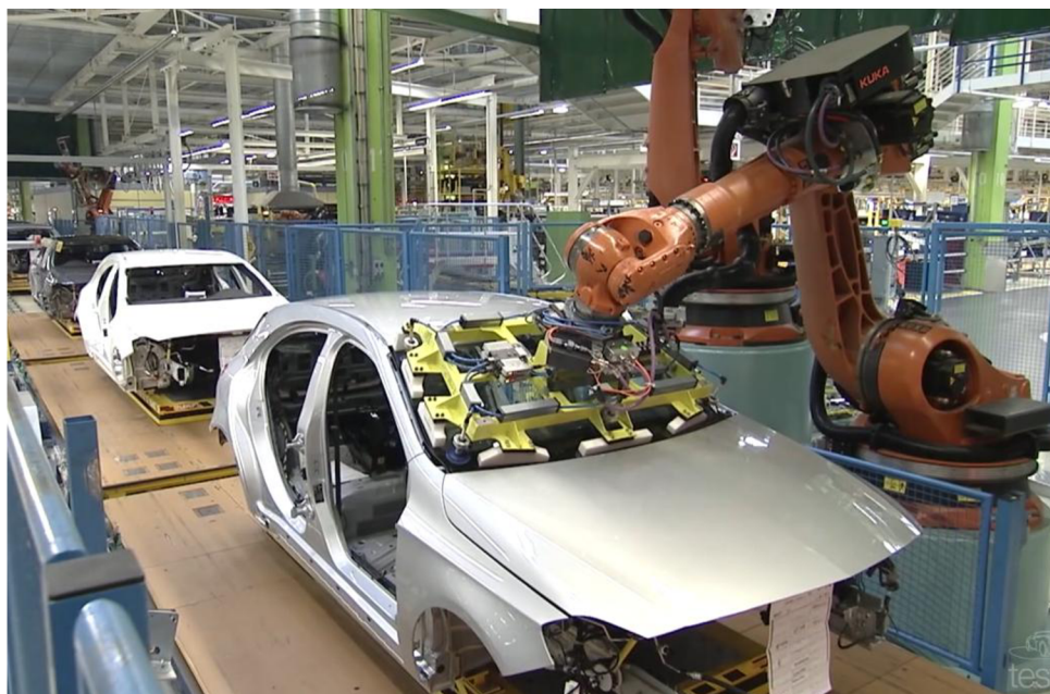
Obr. 15 Montáž čelního skla automobilu Mercedes A-Class [31].
