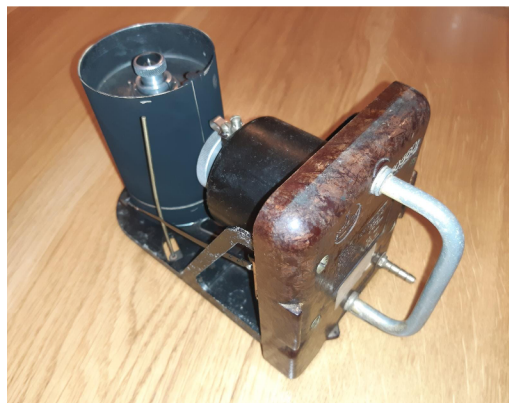
Obrázek 3.1: Barograf pro záznam letové výšky kluzáku.
