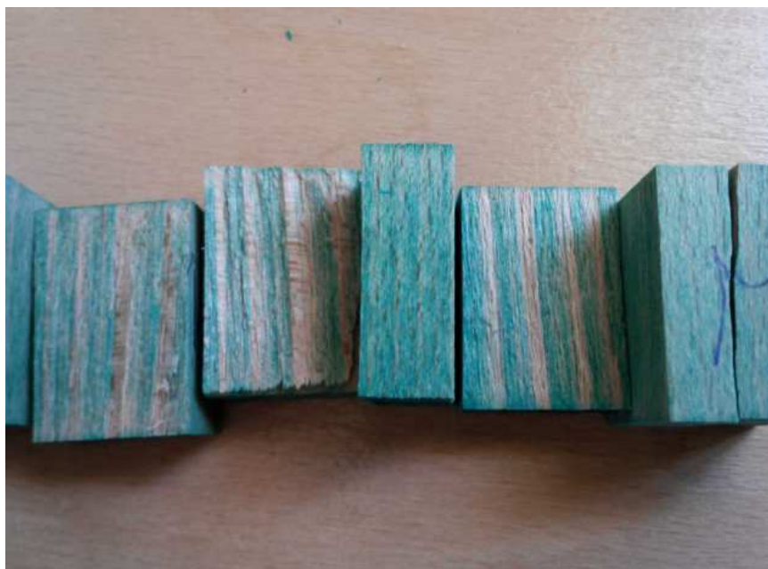
Obr. 9: vybrané zkušební vzorky napuštěné močovinoformaldehydovou pryskyřicí s přidaným barvivem.
