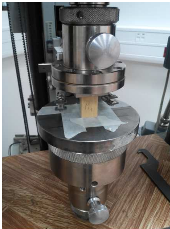
Obr. 12: uložení zkušebního vzorku napuštěného močovinoformaldehydovou pryskyřicí ve zkušebním stroji Zwick.
