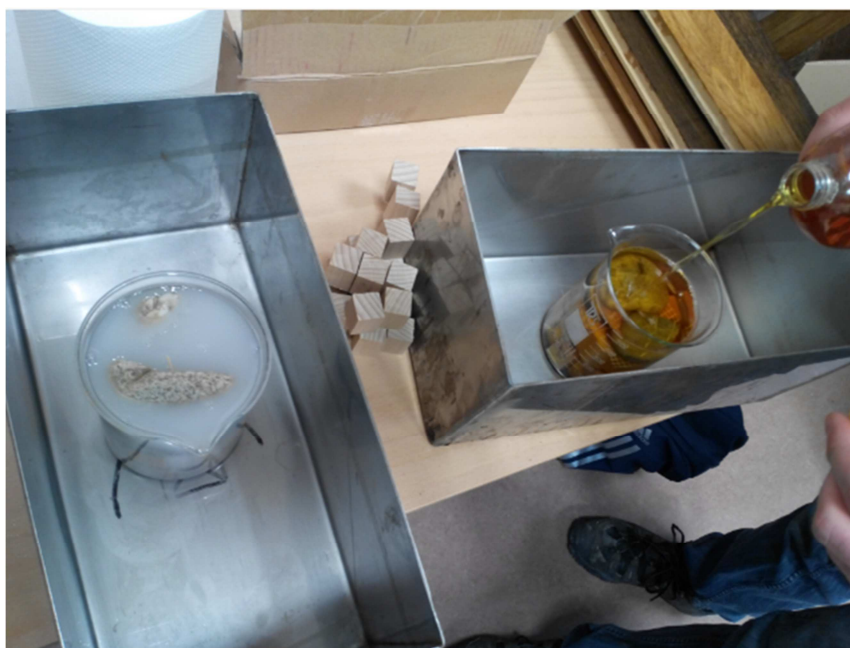
Obr. 5: Naplněné kádinky pryskyřicemi se zkušebními vzorky vložené do nerezových vaniček.
