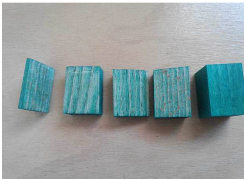
Obr. 8: vybrané zkušební vzorky napuštěné šelakovou pryskyřicí s přidaným barvivem.
