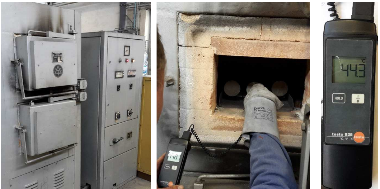
Obr. 37 Předehřívání základního materiálu
