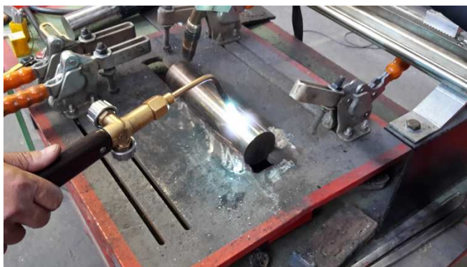
Obr. 40 Ohřev na teplotu předehřevu
