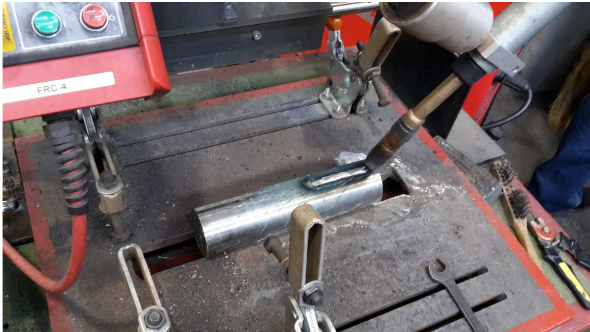
Obr. 38 Navařování housenky Stellite
