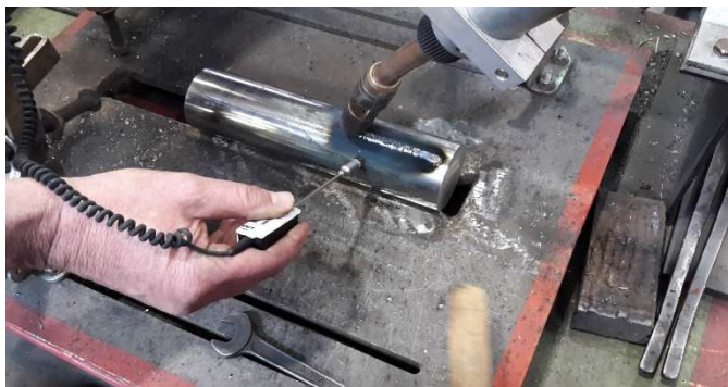
Obr. 39 Měření teploty po navaření housenky
