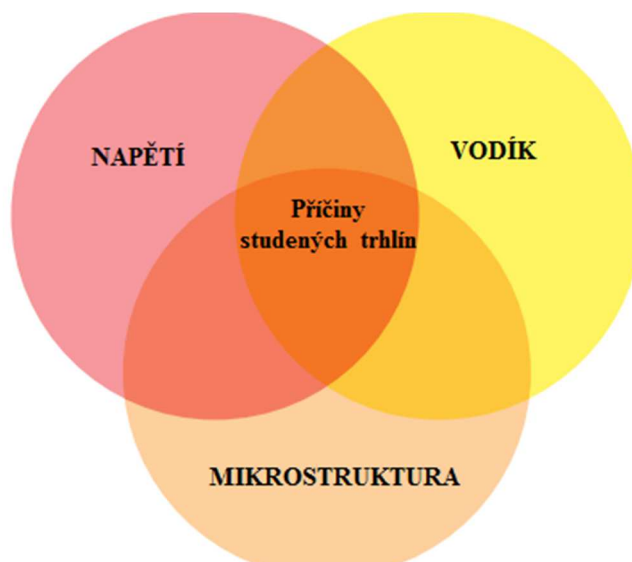
Obr. 19 Příčiny vzniku studených trhlín [22]
