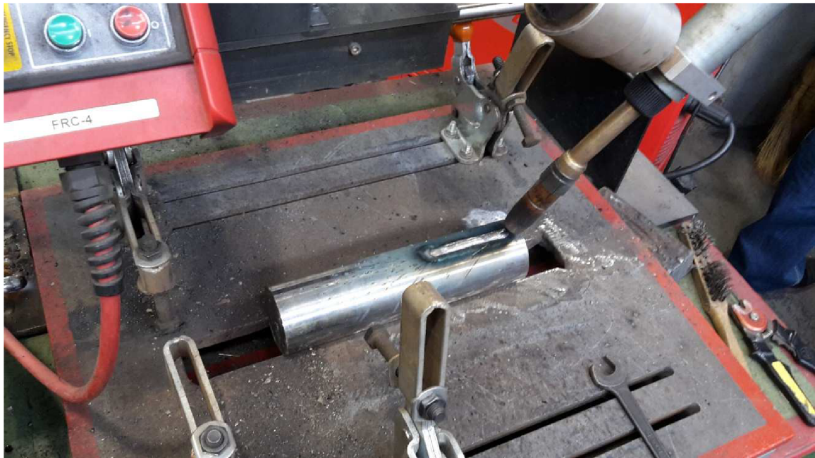
Obr. 38 Navařování housenky Stellitu
