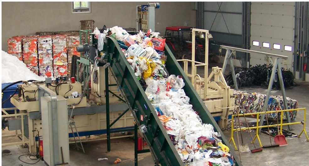
Obr.19: Podávací dopravník k lisu a lis Hofmann 60 tun
