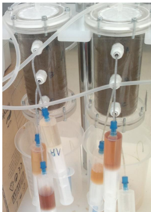
Obrázek 12: Extrakce kovů z kolon pomocí \text{HNO}_3
