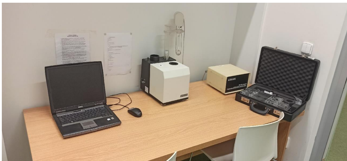
Obr. 5: Střídavý laboratorní můstek – typ KLY-4S Kappabridge s nástavcem a kyvetou. Foto pořizeno Alicí Voráčovou 8. 7. 2021 na Katedře geologie UP.
