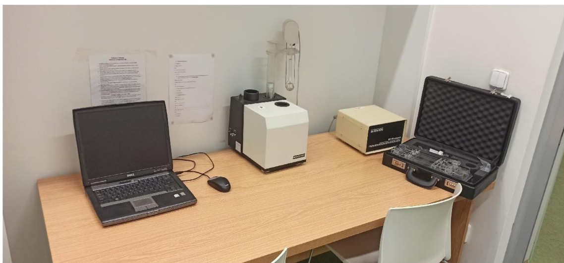
Obr. 5: Střídavý laboratorní můstek – typ KLY-4S Kappabridge s nástavcem a kyvetou. Foto pořízeno Alicí Voráčovou 8. 7. 2021 na Katedře geologie UP.
