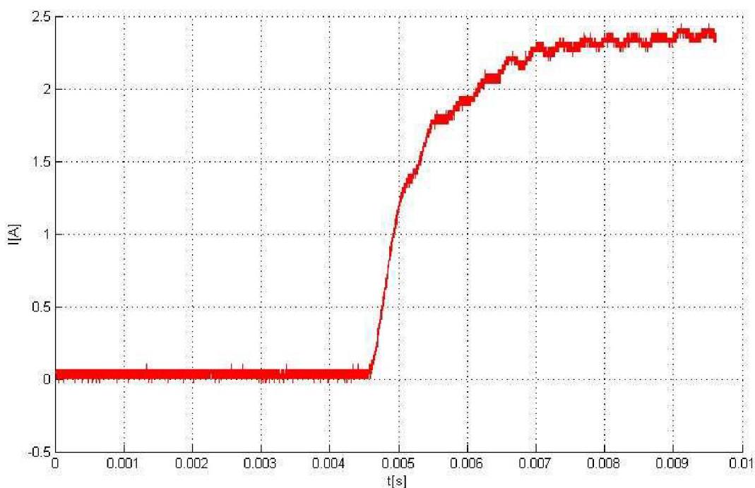
Obrázek 22 Odezva proudu motoru na skok řízení
