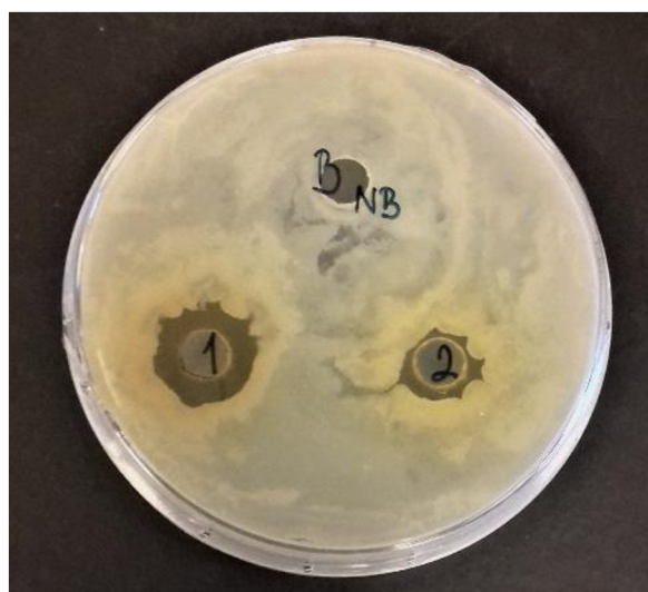
Obr. 26: Antimikrobiální test na agaru; směs 1 (hřebíček + měsíček) a směs 2 (šalvěj * + rozmarýn) proti Escherichia coli
