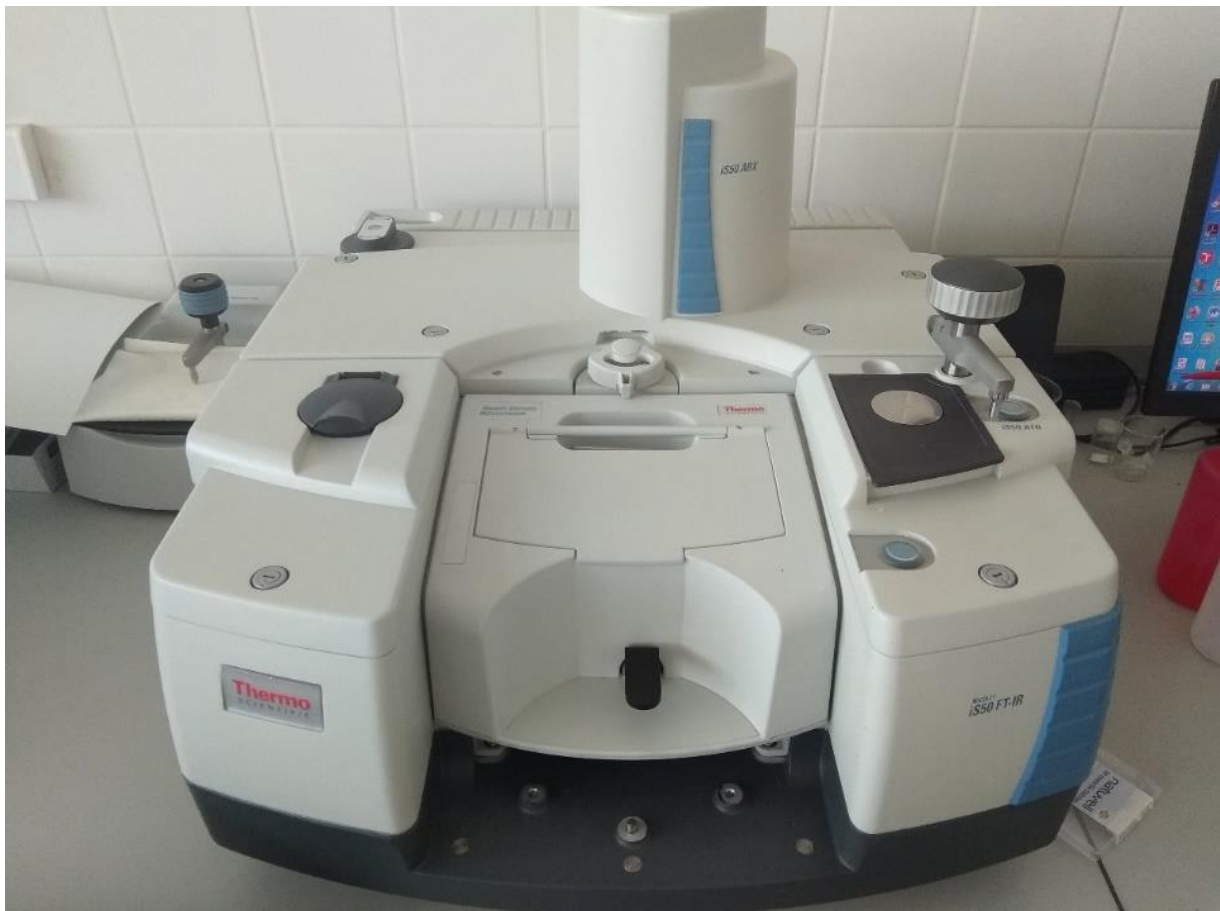
Obrázok 8: Spektrofotometer Nicolet iS50 použitý pri realizovaných analýzach
