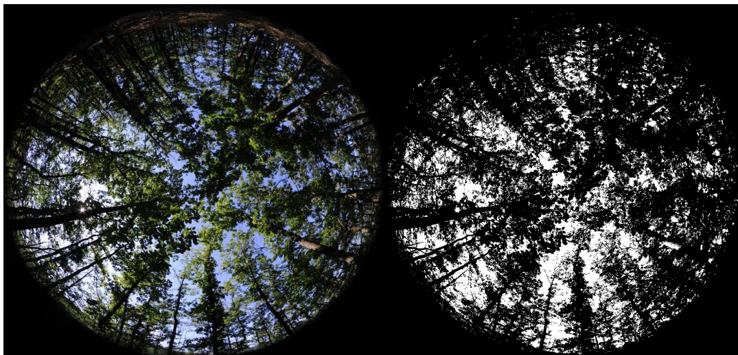
Obrázek 6 Hemisférická fotografie pořízená pomocí objektivu rybí oko (vlevo). Fotografie upravená v programu Gap Light Analyzer (vpravo).
