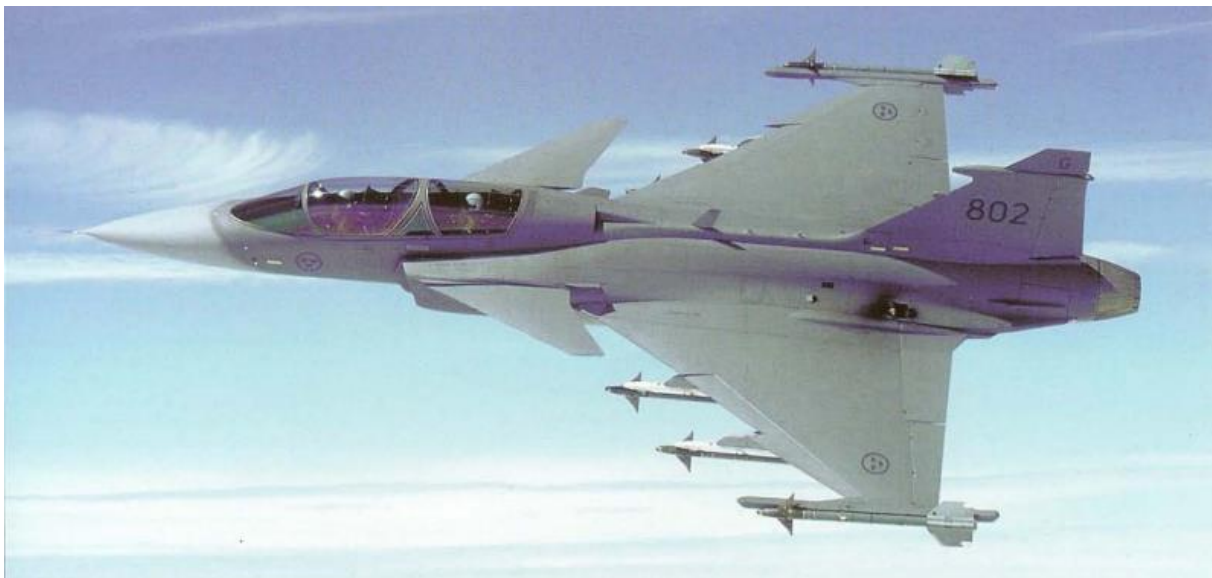
Obr. 8.9 JAS-39B na ktorom sú vidieť jeho dvojité a predĺžené kokpity [18]
