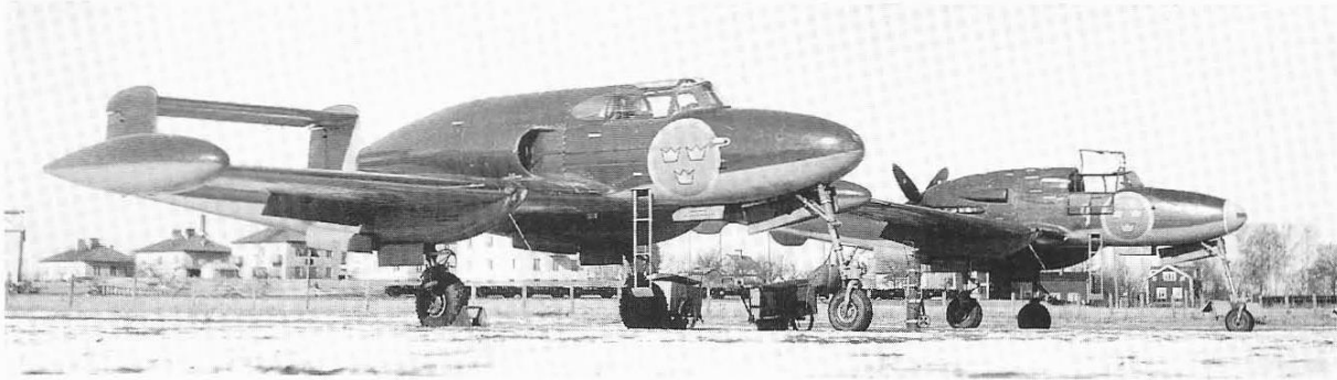
Obr. 3.4 Saab J 21R na ľavo bol prvý stroj, ktorý bol konvertovaný z J 21A [1]
