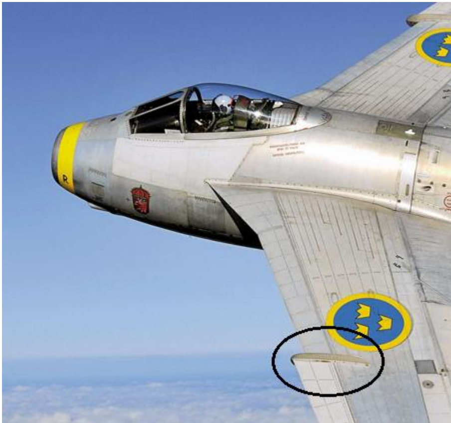
Obr. 4.3 „psí zub“ viditeľný na krídlach Saab 29 [1]
