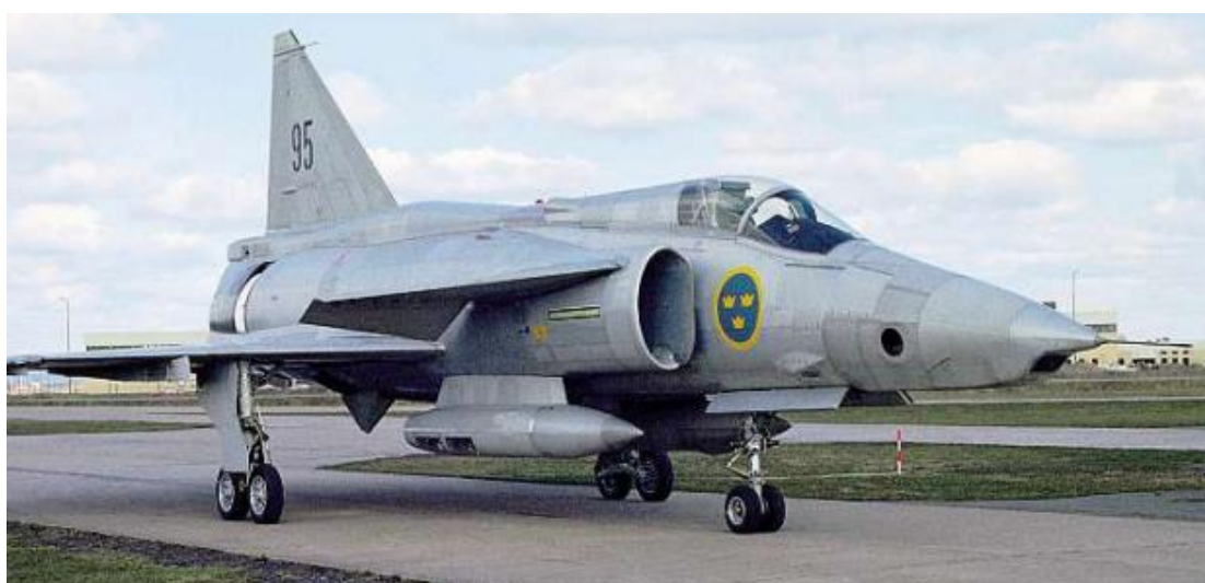
Obr. 7.6 SF 37 Viggen z modifikovanou prednou časťou pre umiestnenie kamier [11]
