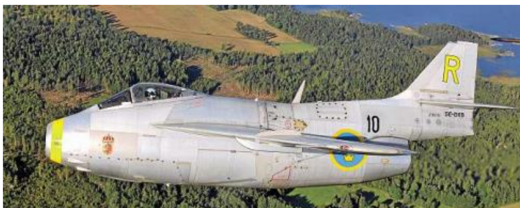
Obr. 4.2 Model Saab J 29F s prídavným spaľovaním [11]
