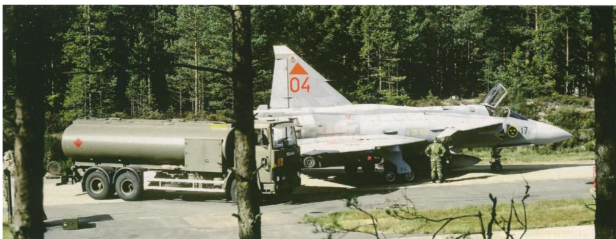
Obr. 2.3 JA 37D, ktorému je dopĺňané palivo medzi misiami pri operácii z ciest. [10]
