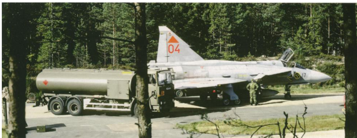
Obr. 2.3 JA 37D, ktorému je dopĺňané palivo medzi misiami pri operácií z ciest. [10]
