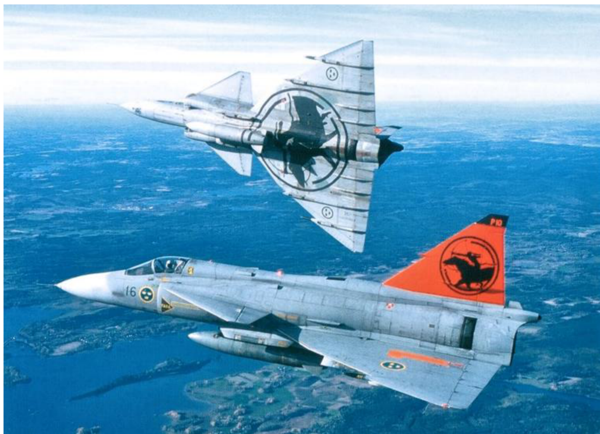
Obr. 7.10 Saab JA37, na ktorom sú vidieť vodorovné predne plochy a súčasne aj nastavenie zvislej chvostovej plochy. Na krídle je viditeľný RWR umiestnený za psím zubom, ktorý sa na dizajn preniesol zo skorších strojov. [12]
