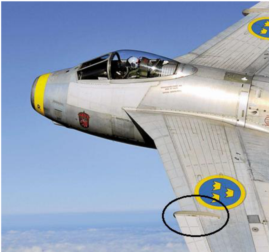
Obr. 4.3 „psí zub“ viditeľný na krídlach Saab 29 [1]
