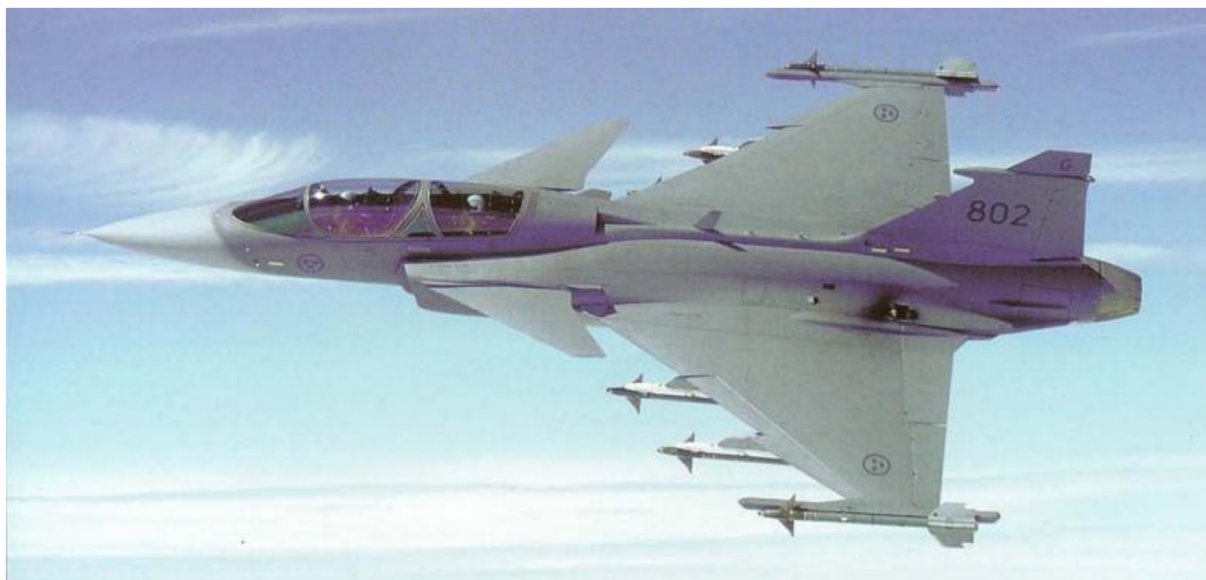
Obr. 8.9 JAS-39B na ktorom sú vidieť jeho dvojité a predĺžený kokpit [18]
