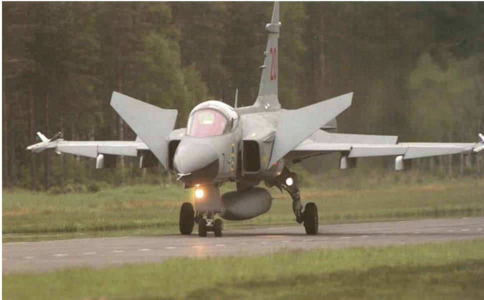
Obr. 8.6 Gripen využívajúci kačacie plochy na brzdenie pri pristávaní [18]
