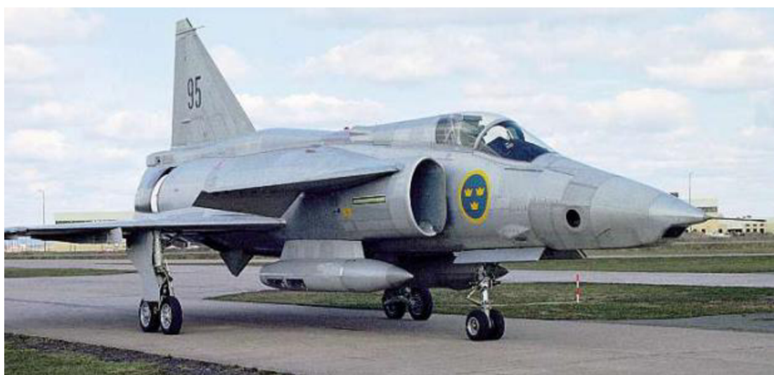
Obr. 7.6 SF 37 Viggen z modifikovanou prednou časťou pre umiestnenie kamier [11]
