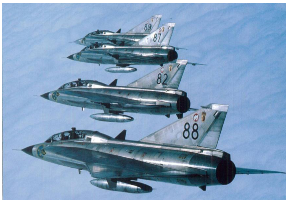
Obr. 6.12 Štyri SK 35C. Pod krídlami si je možné všimnúť podtrupové vertikálne stabilizátory, ktoré pomáhali z problémami pri vybočení. [15]
