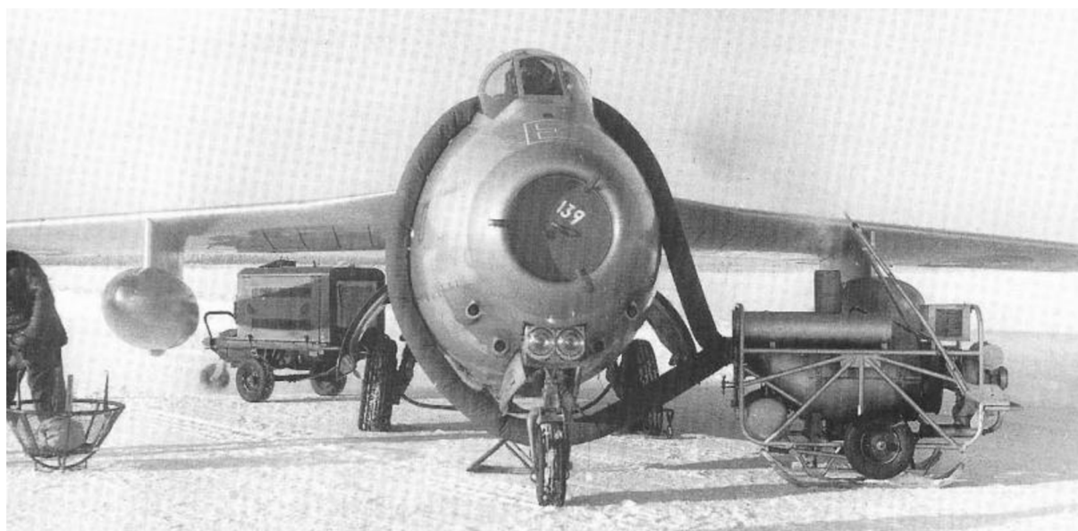
Obr. 4.4 Saab J 29 vyhrievaný generátormi [1]
