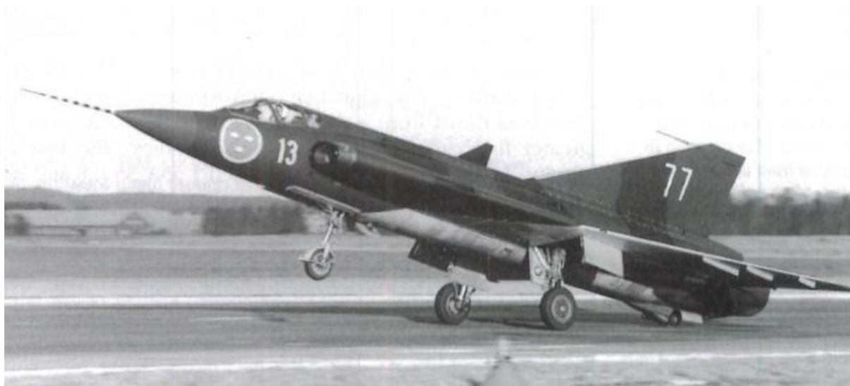
Obr. 6.9 J35A s dlhým chvostom a chvostovým kolesom pri pristávaní. [15]
