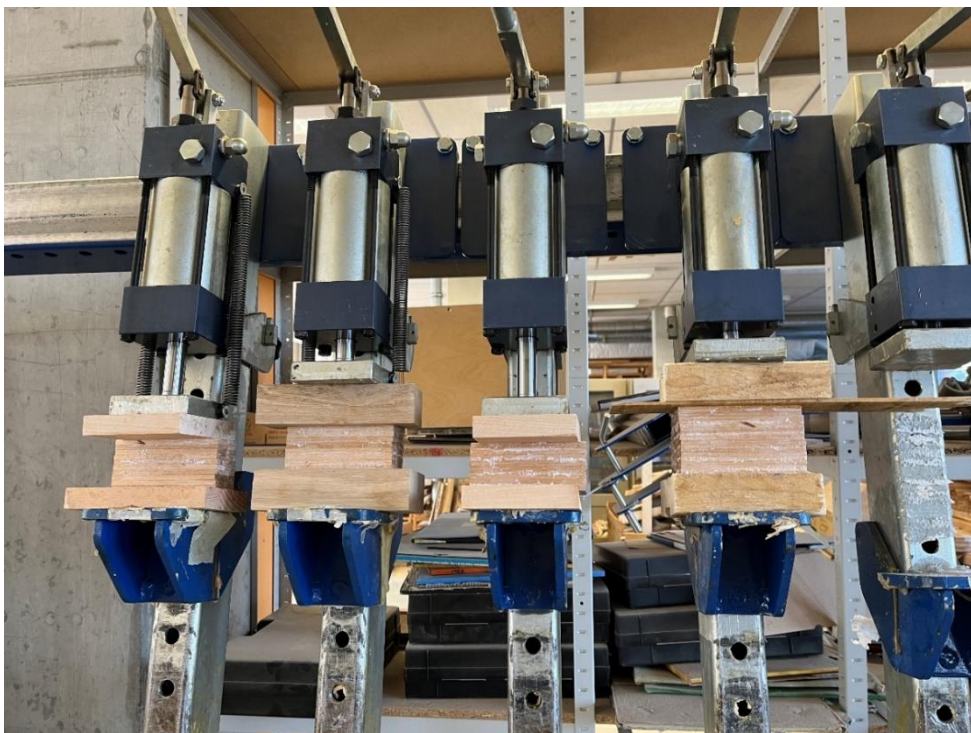
Obrázek 10: Lepení vzorků pro experiment Zdroj: vlastní
