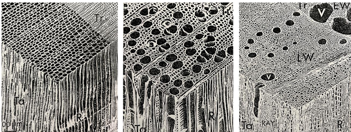
Obrázek 1: Mikrofotografie prostorové struktury dřev a) modřínu b) liliovníku a c) dubu Zdroj: Šlezingerová J., Gandelová L.: Stavba dřeva (1994)
