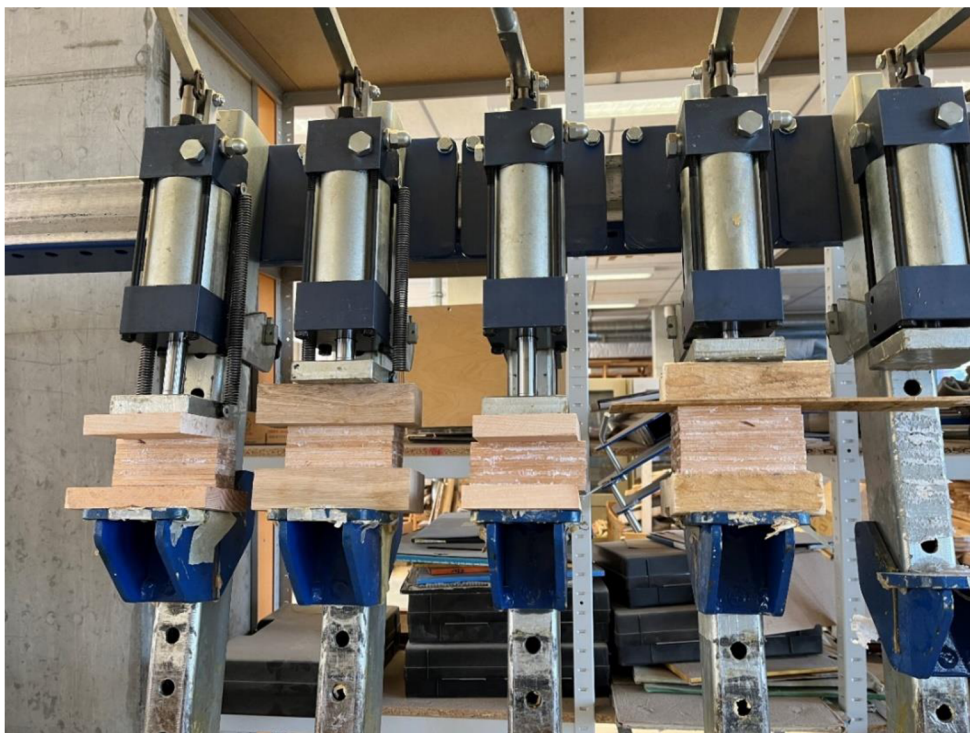
Obrázek 10: Lepení vzorků pro experiment Zdroj: vlastní
