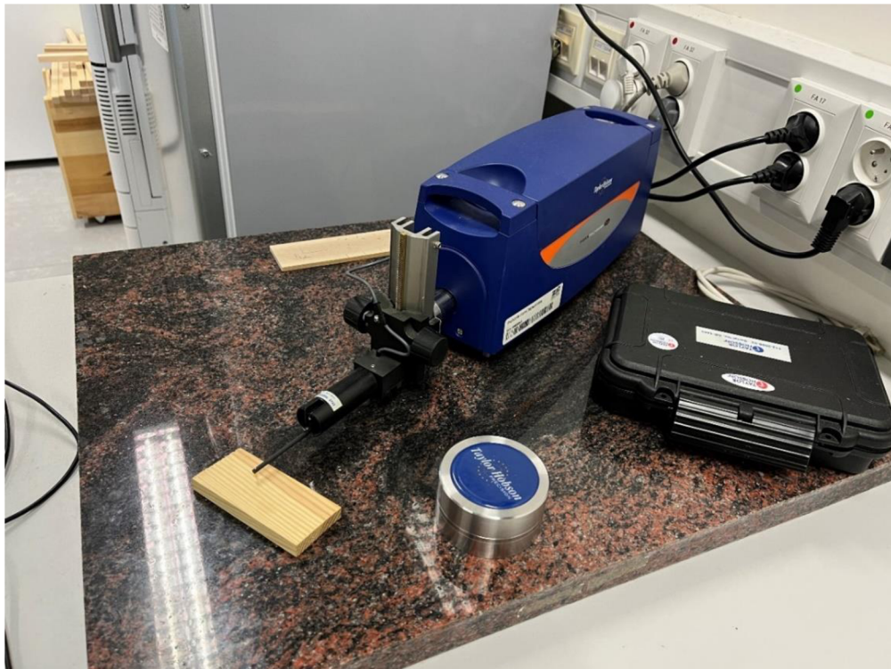
Obrázek 8: Pracoviště pro měření ukazatelů povrchu Zdroj: vlastní, vzorek je ilustrativní
