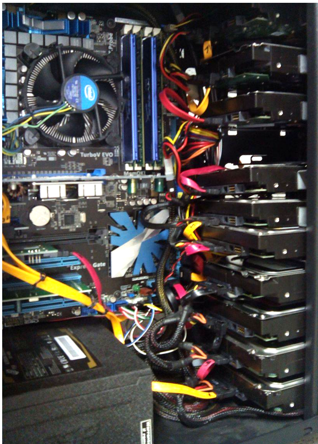
Obr. 6: Fotografie diskového pole Buxus zevnitř ve vypnutém stavu
