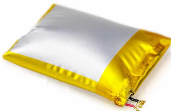
Obrázok č. 6 – Znárodnenie vreckového (laminovaného) článku po nežiadúcom zvýšení vnútorného tlaku [14]
