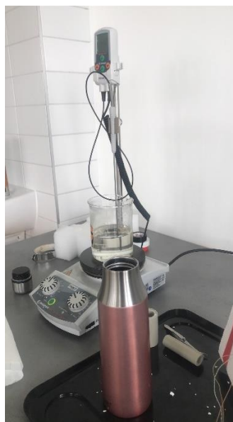
Obrázok č. 17 – Ukážka pracoviska pre batériové články 18650, ohrev oleja, termoska
