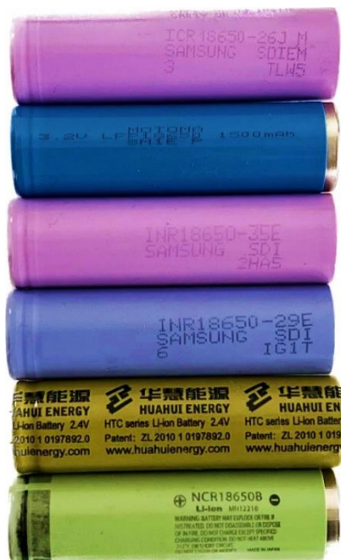
Obrázok č. 22 – Použité batérie pri meraní ich špecifickej tepelnej kapacity
