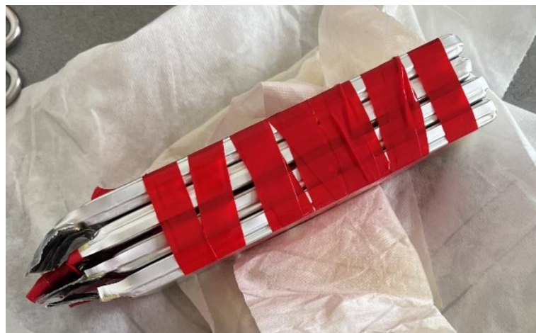
Obrázok č. 23 – Batérie pouch (Grepow) zoskupené a upevnené do jedného bloku
