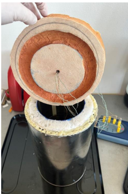
Obrázok č. 20 – Zhotovený objemnejší kalorimeter s termočlánkami typu K
