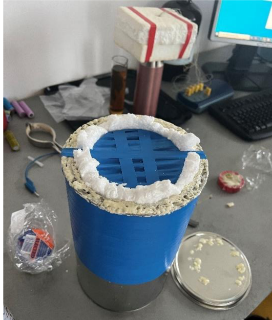
Obrázok č. 18 – Vyplnenie medzeri medzi jednotlivými nádobami pištoľovou penou Ceresit WhiteTeq
