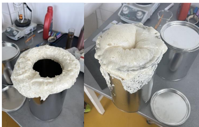
Obrázok č. 19 – Vľavo nezaschnutá čerstvo nastriekaná PUR pena, vpravo výsledok na ďalší deň
