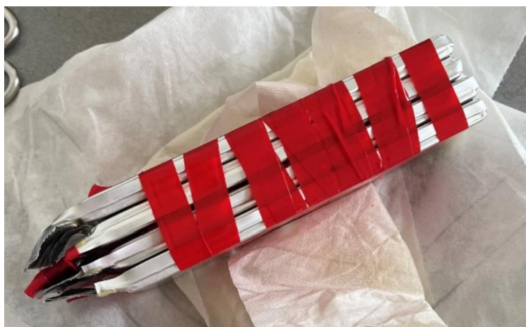
Obrázok č. 23 – Batérie pouch (Grepow) zoskupené a upevnené do jedného bloku
