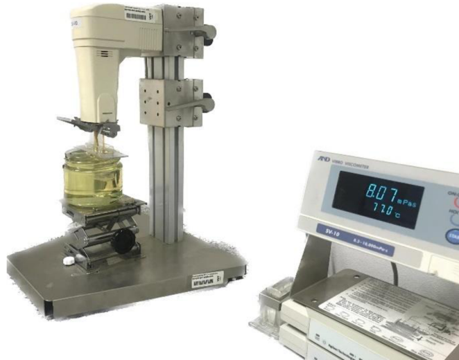
Obrázok č. 21 – Meranie viskozity laboratórnym viskozimetrom AND Vibro viscosimeter SV-10
