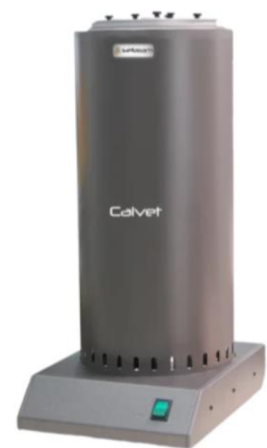
Obrázok č. 16 – Kalorimeter typu Calvet C80 [42]
