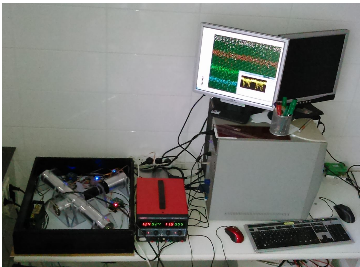
Fotografie vyvinutého Mössbauerova spektrometru s časovým rozlišením.
