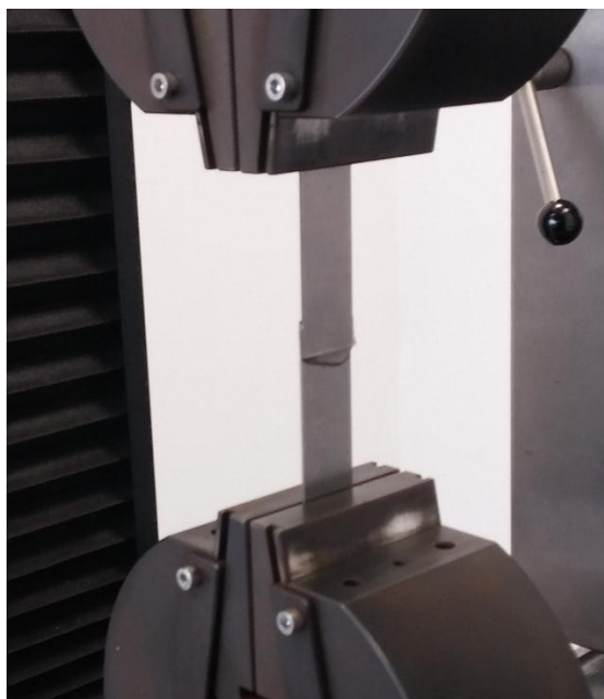
Obr. 31 Vzorek upnutý do čelistí zkušebního stroje
