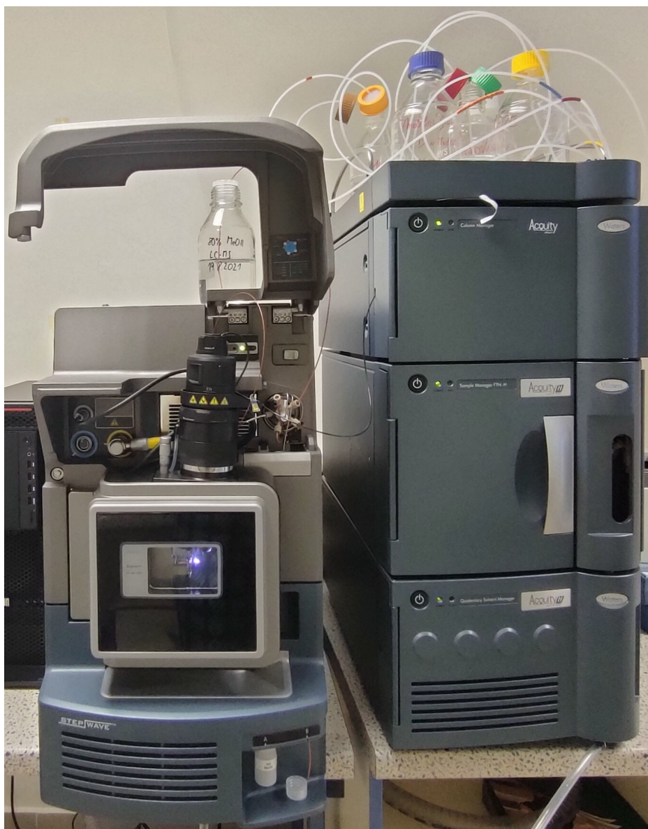
Obrázek 4.2: Acquity UPLC-XEVO TQS micro – využitý pro experimentální část
